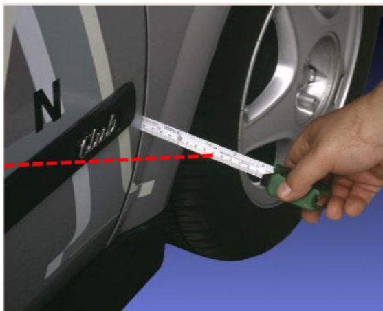
Проверка нижней части установки молдинга
